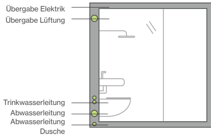
Bei der seitlichen Steigleitung (bauseits zu installieren) können die Module um die Steigleitung bzw. den Schacht herum frei angeordnet werden, solange diese an den Positionen A, B und C anschließbar sind.
