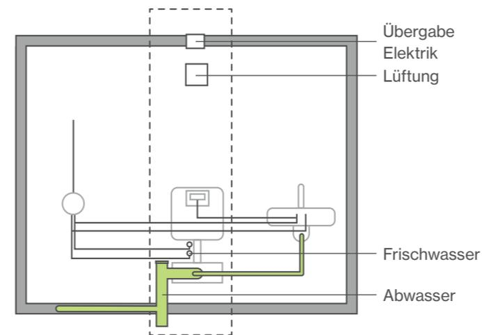
Bei der integrierten Steigleitung (bauseits zu installieren) müssen die Badmodule für den Anschluss des Abwasserrohrs (Position B) übereinander stehen. Der Bereich für die Anschlüsse muss zugänglich sein.
